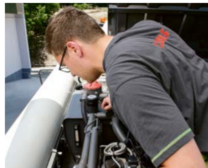
Простий візуальний контроль рівнів заповнення оливою усіх систем.
